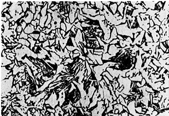
70% Ferrit, 5% Perlit, 20% Zwischenstufen- gefüge, 5% Martensit Härte 181 HV
