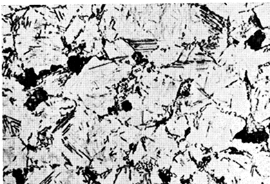
7% Perlit, 12% Zwischenstufengefüge, 81% Martensit Härte 640 HV
