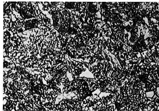
15% Ferrit, 75% Zwischenstufengefüge, 10% Martensit Härte 37 HRc
