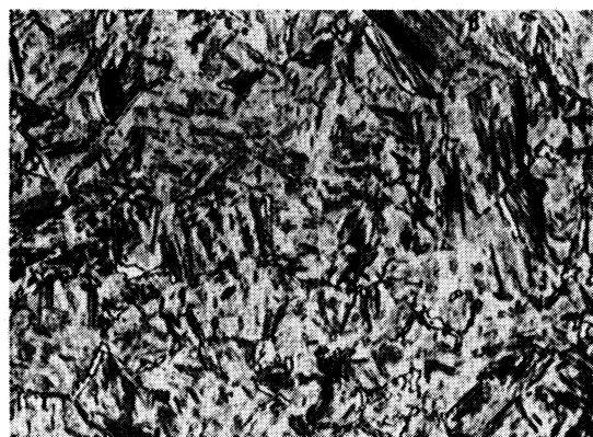
1% Ferrit, 10% Zwischenstufengefüge, 89% Martensit Härte 58 HRc
