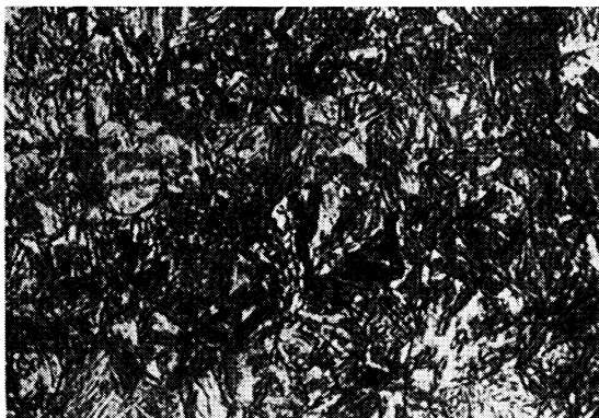
40% Zwischenstufengefüge, 60% Martensit Härte 46 HRc
