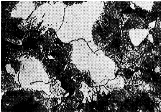
50% Ferrit, 50% Perlit Härte 225 HV
