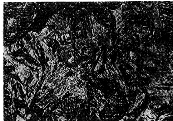
Ungelöste Karbide, Martensit Härte 430 HV
