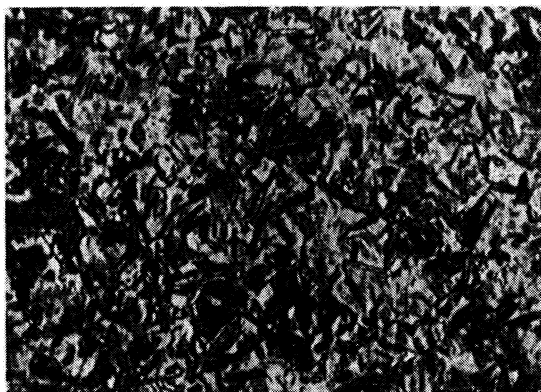
30% Zwischenstufengefüge, 70% Martensit Härte 52 HRc
