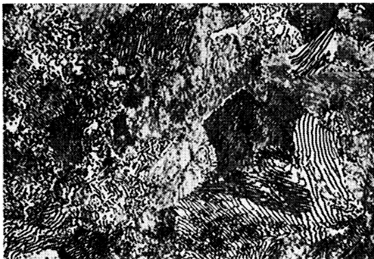
Ungelöste Karbide, 7 % Ferrit, 93 % Perlit
