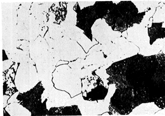
70% Ferrit, 20% Perlit, 10% Zwischenstufengefüge, Spuren Martensit Härte 81 HRb
