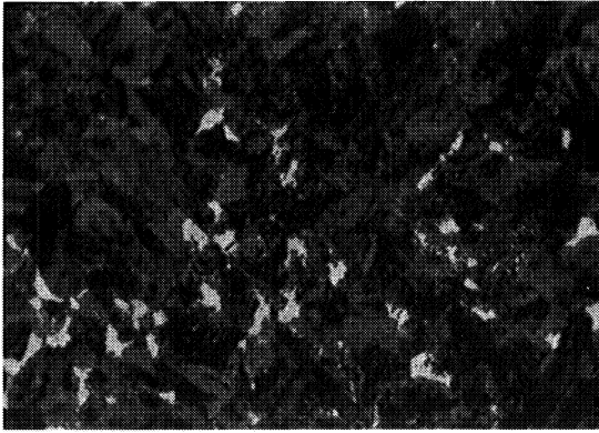
Umwandlungstemperatur 660° C 5% Ferrit, 95% Perlit Härte 27 HRc
