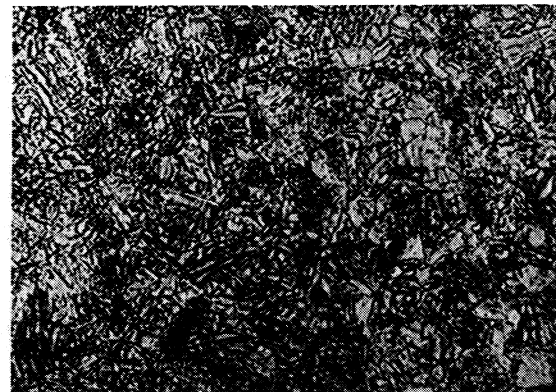
Ungelöste Karbide, Martensit Härte 417 HV
