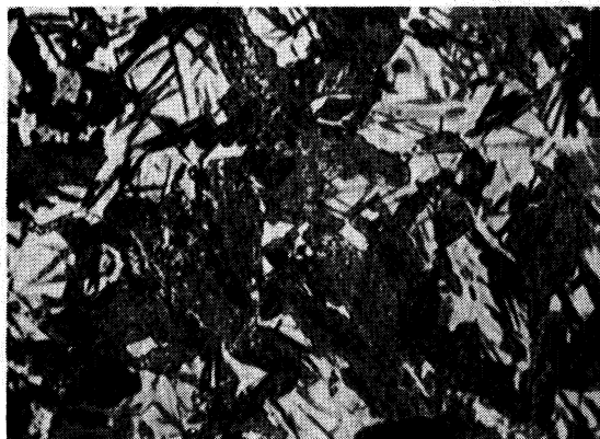
65% Zwischenstufengefüge, 35% Martensit Härte 45 HRc
