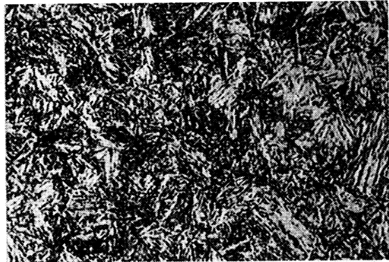
Umwandlungstemperatur 310° C Zwischenstufengefüge Härte 576 HV
