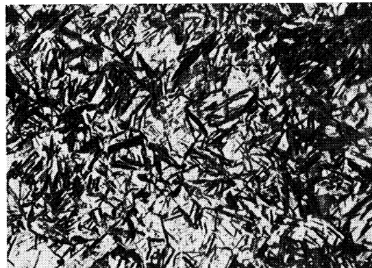
Ungelöste Karbide, 55% Zwischenstufengefüge, 45% Martensit und Restaustenit Härte 599 HV
