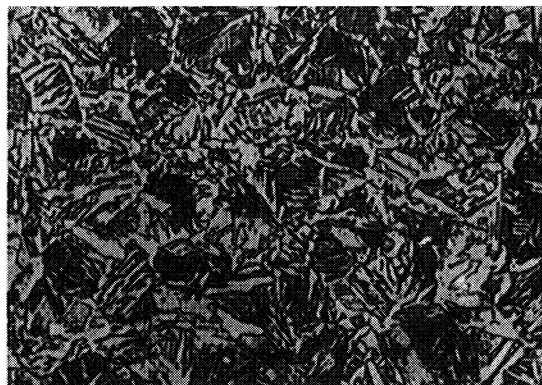
20% Ferrit, 40% Zwischenstufengefüge, 40% Martensit Härte 24 HRc
