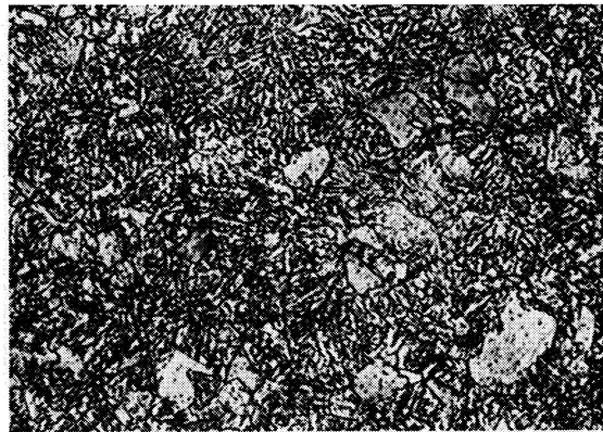
Ungelöste Karbide, 10% Eutektoid F + K, 83% Zwischenstufengefüge, 7% Martensit und Restaustenit Härte 404 HV
