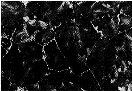
Perlit mit Zementitnetzwerk Härte 38 HRc
