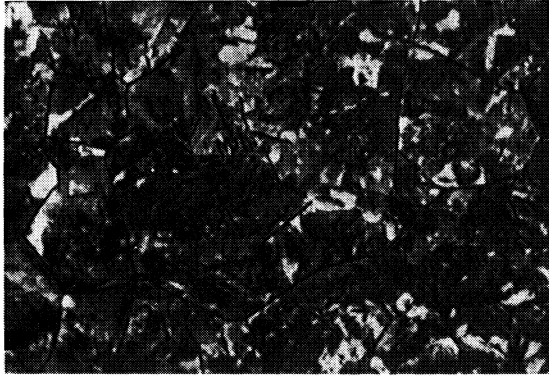
Umwandlungstemperatur 580° C Perlit mit Zementitnetzwerk und -nadeln Härte 40 HRc
