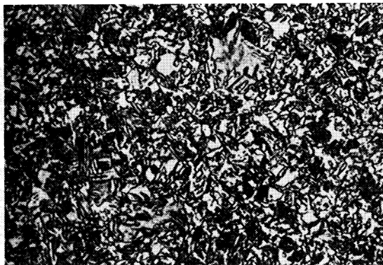
20% Ferrit, 38% Perlit, 32% Zwischenstufengefüge, 10% Martensit Härte 315 HV
