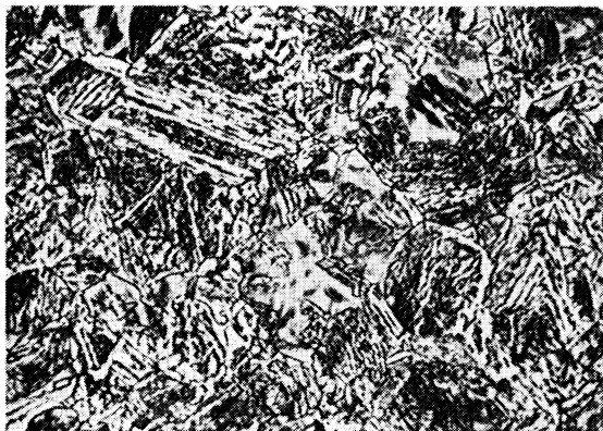
60% Zwischenstufengefüge, 40% Martensit Härte 37 HRc
