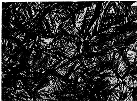
Ungelöste und voreutektoidische Karbide, 70% Zwischenstufengefüge, 30% Martensit und Restaustenit Härte 587 HV
