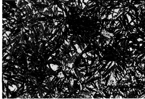
Umwandlungstemperatur 300° C Ungelöste Karbide, 70% Zwischenstufengefüge, 30% Martensit und Restaustenit Härte 583 HV
