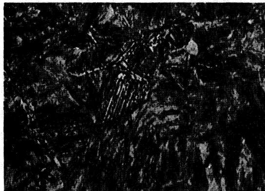
25% Zwischenstufengefüge, 75% Martensit Härte 40 HRc
